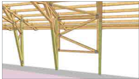
Bilde: Viser prosjektilpasset avstivningsramme.
