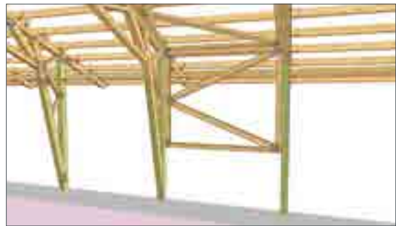
Bilde: Viser prosjektilpasset avstivningsramme.
