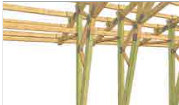
Bilde: Viser sammensatte takstolrammer for økt spenn, og lengre cc-avstand.
