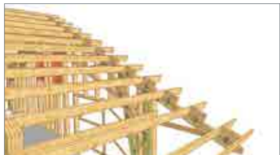
Bilde: Viser detalje for enkel montasje av takåser med ferdigmonterte klosser.
